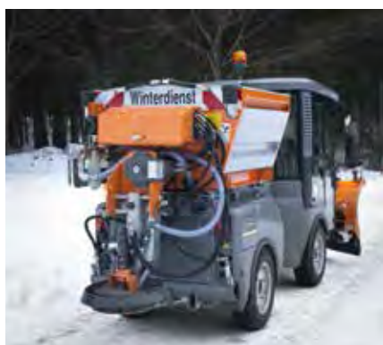
MC 130, posipač za mokro posipanje soli
