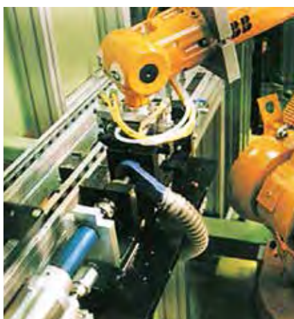
Ringler usisna mlaznica za točno usisavanje strugotina od glodanja
