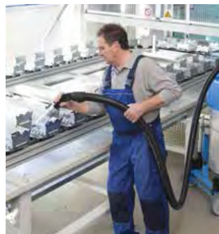
Usisavanje strugotina i maziva za hlađenje prilikom održavanja strojeva i postrojenja
