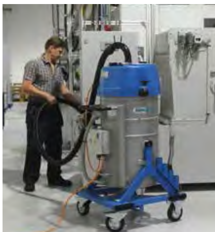
Usisavanje maziva za hlađenje prilikom zamjene
